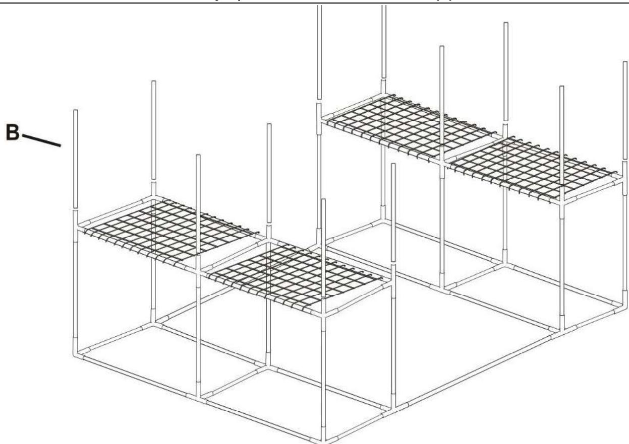
B) Použijte 2 spojky (04), 8 spojky (02), 8 trubek (C), 6 trubek (A) a 1 trubku (D) a smontujte podle obrázku níže druhou úroveň konstrukce.
