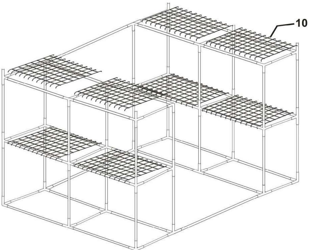
B) Použijte 4 spojky (01), 2 spojky (05), 6 trubek (B), 4 trubek (C) a smontujte podle obrázku níže třetí úroveň konstrukce.
