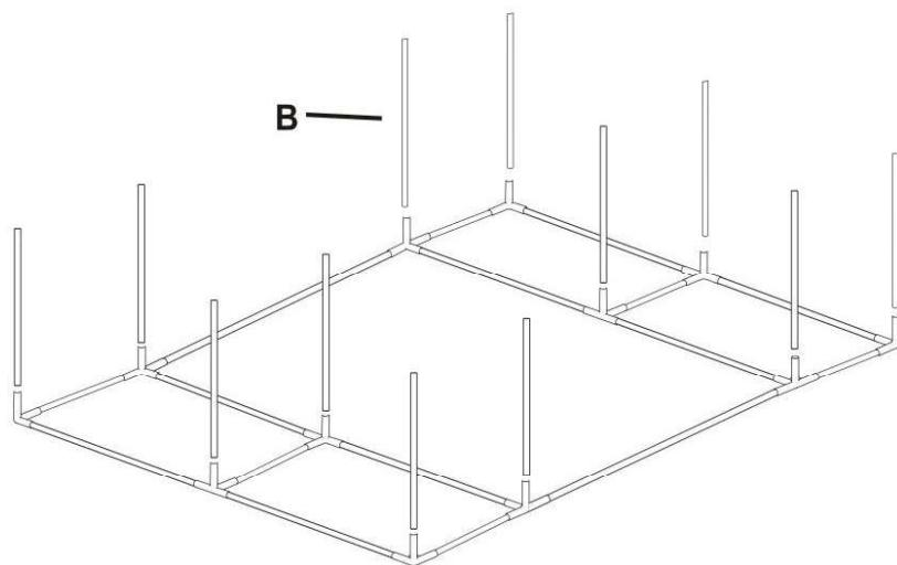
B) Použijte 2 spojky (04), 4 spojky (02), 8 trubek (C) a 6 trubek (A) a smontujte podle obrázku níže druhou úroveň konstrukce.
