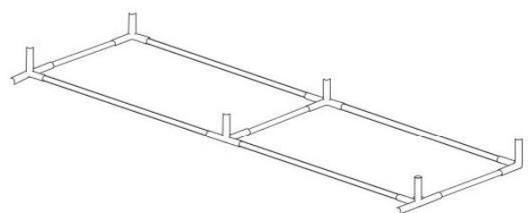
E) Smontované části konstrukce spojte dohromady pomocí 2 trubek (2)
