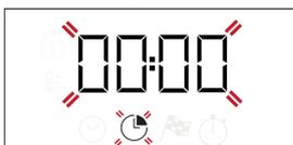
K nastavení požadované doby přípravy použijte **+** nebo **-**, poté potvrďte stisknutím . Aktivujte funkci otočením ovladače termostatu na požadovanou teplotu: Zazní zvukový signál a na displeji se zobrazí, že je pečení ukončeno.
