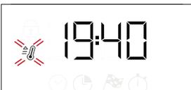
Upozornění: Během pečení můžete změnit funkci otočením **ovladače výběru** nebo upravit teplotu otočením **ovladače termostatu**. Funkce se nespustí, pokud bude **knoflík termostatu** v poloze **0 / AUTO**. Můžete nastavit dobu přípravy, čas ukončení (pouze nastavíte-li dobu přípravy) a časovač.
