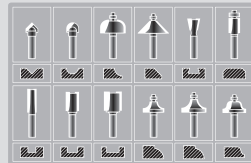
Obr. 1, tvar profilů v závislosti na použité tvarové fréze
