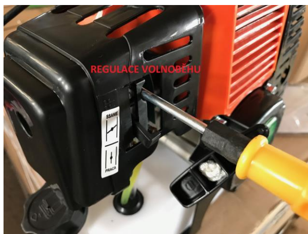
(1): Nastavovací šroub volnoběžných otáček (křížový šroub)
