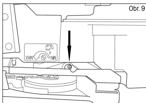
stopy po oleji, mazání řetězu probíhá správně. Nebudou-li na zemi žádné stopy oleje, nastavte sílu mazaní na spodní straně pily (Obr. 9)
