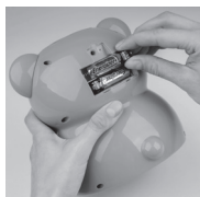
Vložte 2xAA (tužkové) baterie (dbejte na správnou polaritu)
