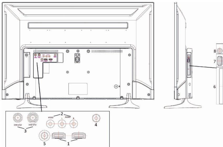
1. **HDMI1 (MHL)/HDMI2 IN:** Připojení vstupního signálu HDMI ze zdrojů signálu, jako je přehrávač DVD. HDMI1 podporuje funkci MHL.
