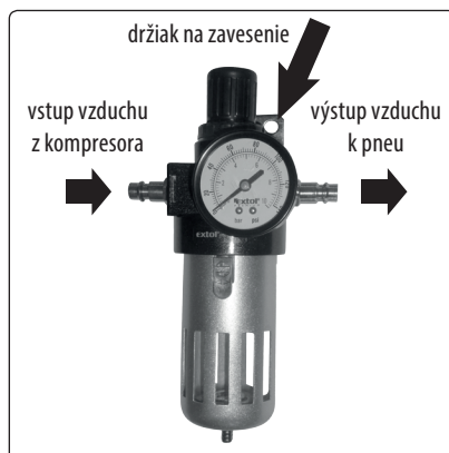
Obr. 7, popis regulátoru tlaku s manometrom a filtrom Extol® 8865104
