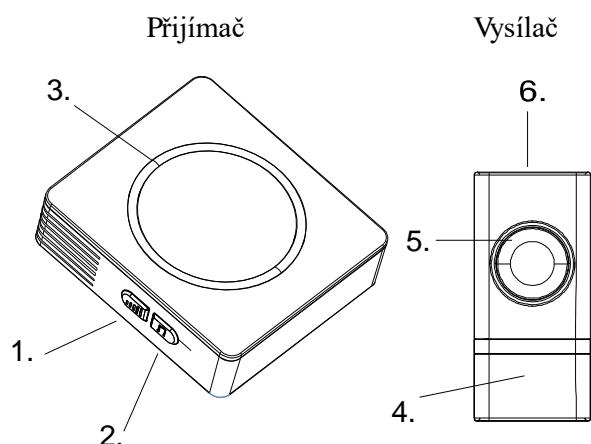
**Poznámka:** Zvonek pracuje na frekvenci 433MHz. Dosah je maximálně 120m na otevřeném prostranství. Baterie do vysílače je alkalická 12V/23A (LR23A).
