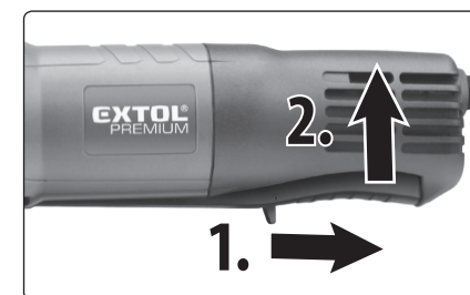
Obr. 6B, zapnutie brúsky Extol® Premium 8892025
