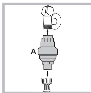
1. Povezivanje hladnu vodu iz slavine s navojem 3/4 plina ulaznog uređaja A, zatim spojite na njega vijcima dovodnom. Prije povezivanja, pokrenite vodu dok se ne radi jasno. Za pravilnu ugradnju uređaja, slijedite upute u pakiraju.
