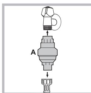
1. Συνδέστε τη συσκευή A σε έναν κρουνό κρύου νερού με στόμιο σπειρώματος 3/4 gas και, στη συνέχεια, βιδώστε επάνω του το σωλήνα τροφοδοσίας. Πριν από τη σύνδεση, αφήστε να τρέξει το νερό μέχρι να γίνει διαυγές.
