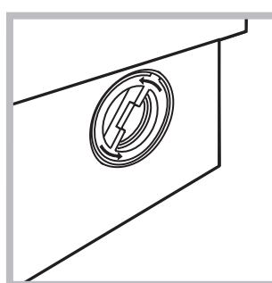
2. Odšroubujte víko jeho otáčením proti směru hodinových ručiček (viz obrázek): vytečení malého množství vody je zcela běžným jevem;
