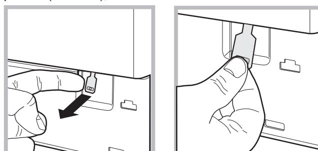
4. povucite prema vani jezičak prikazan na slici, sve dok ne otkočite plastični remen, kojeg zatim treba povući prema dole otvarajući istovremeno vrata;
