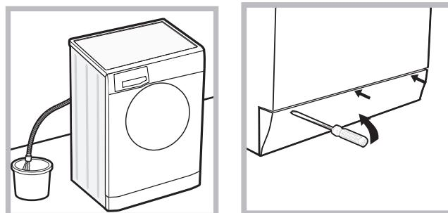
2. provjerite da je razina vode u unutrašnjosti stroja niža od otvora vrata; u suprotnom, pomoću odvodne cijevi ispraznite višak vode u kantu, kako je prikazano na slici;
