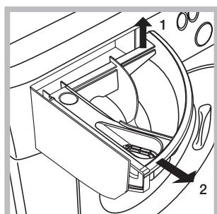
Izvucite pretinac podižući ga i povlačeći prema vani (vidi sliku). Operite ga u tekućoj vodi; ovo čišćenje treba često vršiti. frequently.
