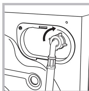
2. Spojite dovodnu cijev na perilicu navijanjem na odgovarajući otvor za uzimanje vode na stražnjoj strani gore desno (vidi sliku).
