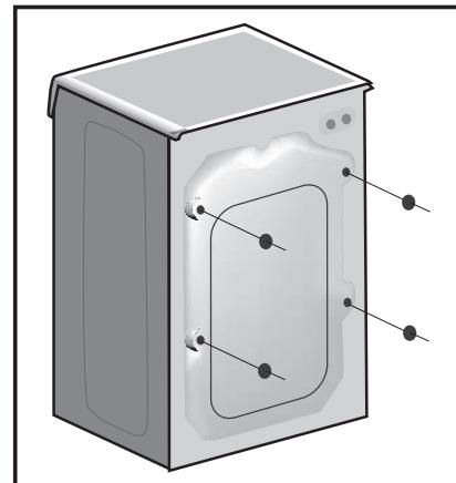
Upevněte ke dnu pračky přiložený protihlukový štít z vlnitěho materiálu podle obrázku.
