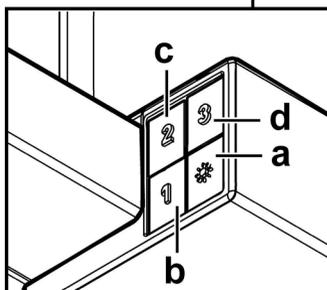
a. Prekidač za svjetlo uključi /isključi ON/OFF.
