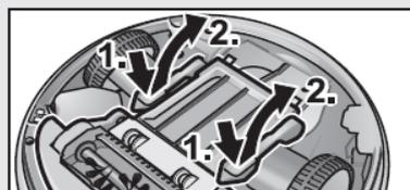
Obr. 16: Otevření uzávěrové páčky nádoby na nečistoty
