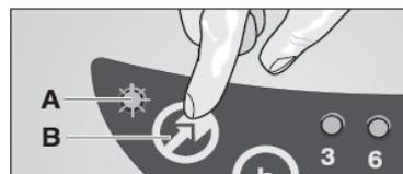
Obr. 9: Parkování robota
