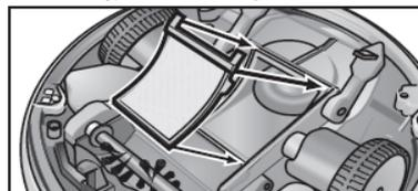
Obr. 19: Vsazení plochého filtru
