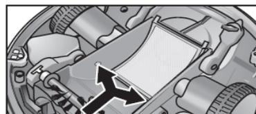
Obr. 23: Čištění prachových senzorů
